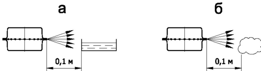
Рис.1. Размеры зон пожароопасности ГОА, а - при испытаниях с горючей жидкостью, б - при испытаниях с горючим твердым материалом.
