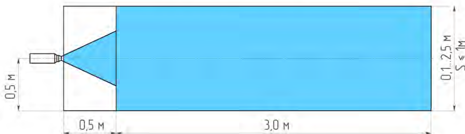
Рисунок 3 – Конфигурация зоны защиты модуля МПП, при горизонтальном монтаже модуля, для очагов класса «А» и «В»
