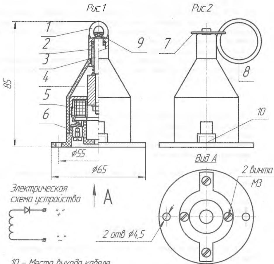
5.2. При превышении температуры окружающей среды срабатывает элемент термочувствительный (1), который освобождает в корпусе (2) подпружиненный шток (3). На штоке закреплен магнит (4), который проходит через индукционную катушку (5) и вырабатывает в ней импульс, через контакты (6), поступающий по соединительным проводам на побудительную систему установки пожаротушения и/или средства сигнализации.
