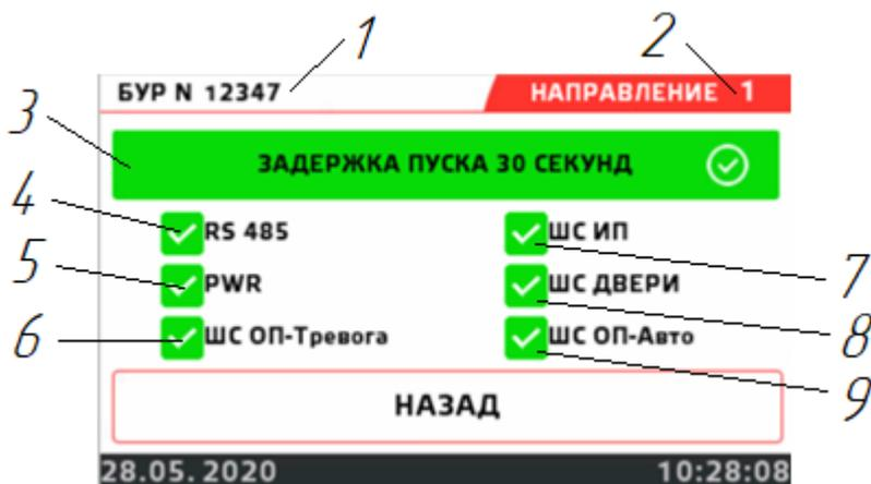
Рисунок 17. Экран подробной информации о состоянии БУР исп. А выбранного направления.
