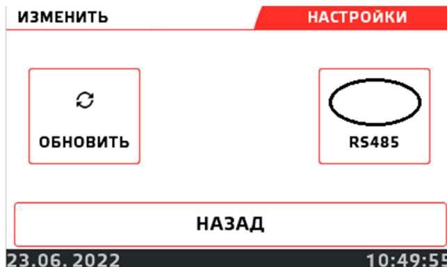
Рисунок 4.15. Изменение режима работы RS485 и обновление конфигурации.
