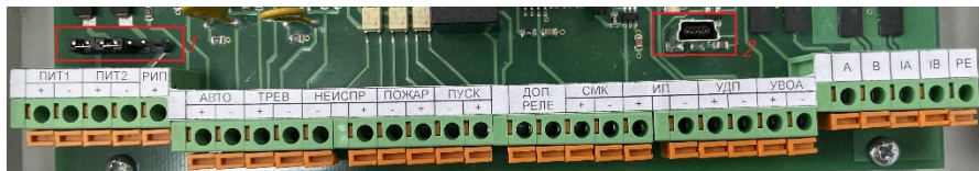
Рисунок 4.4 Схема размещения клеммников, разъемов и джамперов коммутации питания БУР исп. А.
