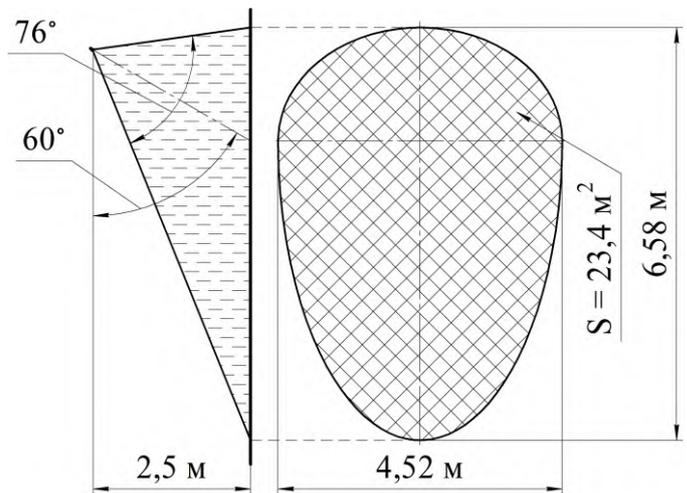
Рисунок 19 - Область орошения на вертикальной плоскости
