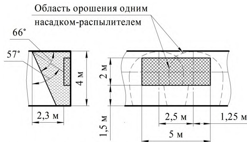
Рисунок 10. Противопожарная защита навесного шкафа 2-мя насадками-распылителями
